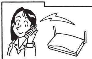
ディジタルシステムコードレス接続装置からの電波の届く範囲（エリア）で内線電話機として使用できます。（☞P39）
